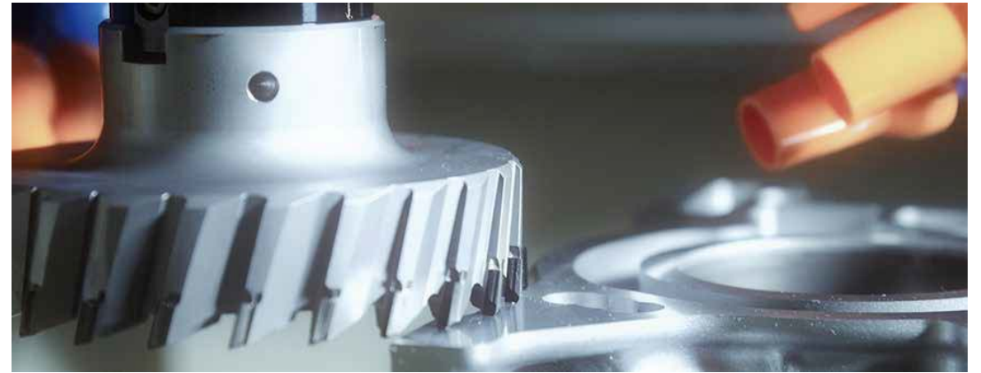
多刃ダイヤモンドフェースミルによる加工
