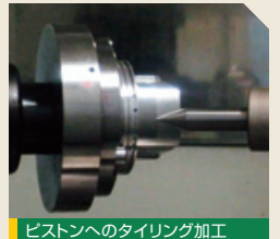
ピストンへのタイリング加工
