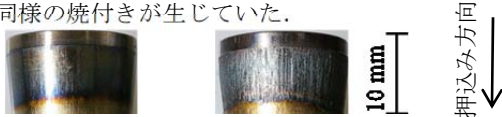
a) エメリ紙#320周方向研磨 b) 研削のままのテーパプラグ使用 試験後のテーパプラグの表面
